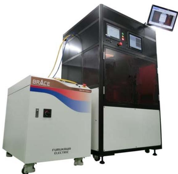
図 1. モータ用レーザー溶接機外観
